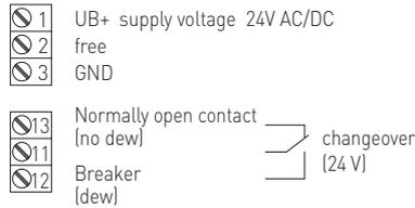
Schema di collegamento (con condensa) **TW-UW**
