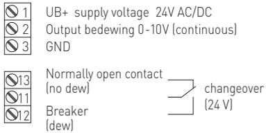
Schema di collegamento (senza condensa) **TW-W**
