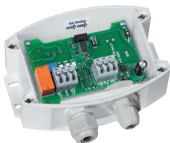
PLSW-W24 con contatto in scambio, UB = 24V
