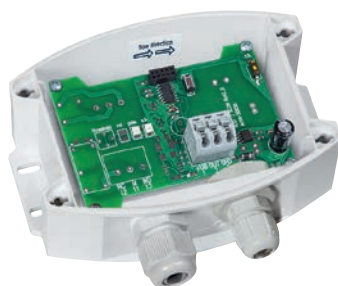
PLGF-U con uscita 0-10V, UB = 24V
