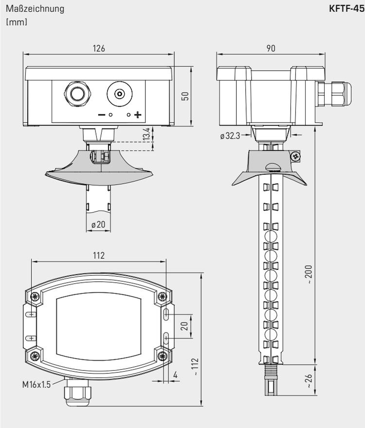
KFTF-45 mit Sinterfilter
